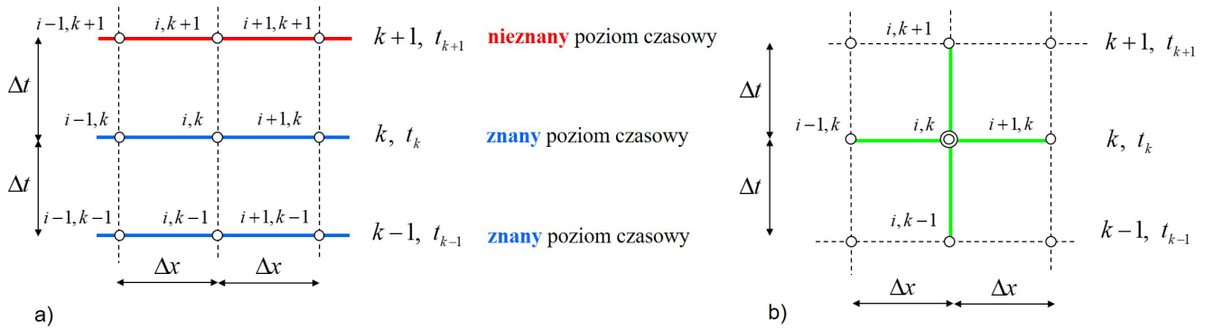
Rys. 2.2.2: Konfiguracja węzłów do budowy operatorów różnicowych a) trzy poziomy czasowe, b) schemat jawny
